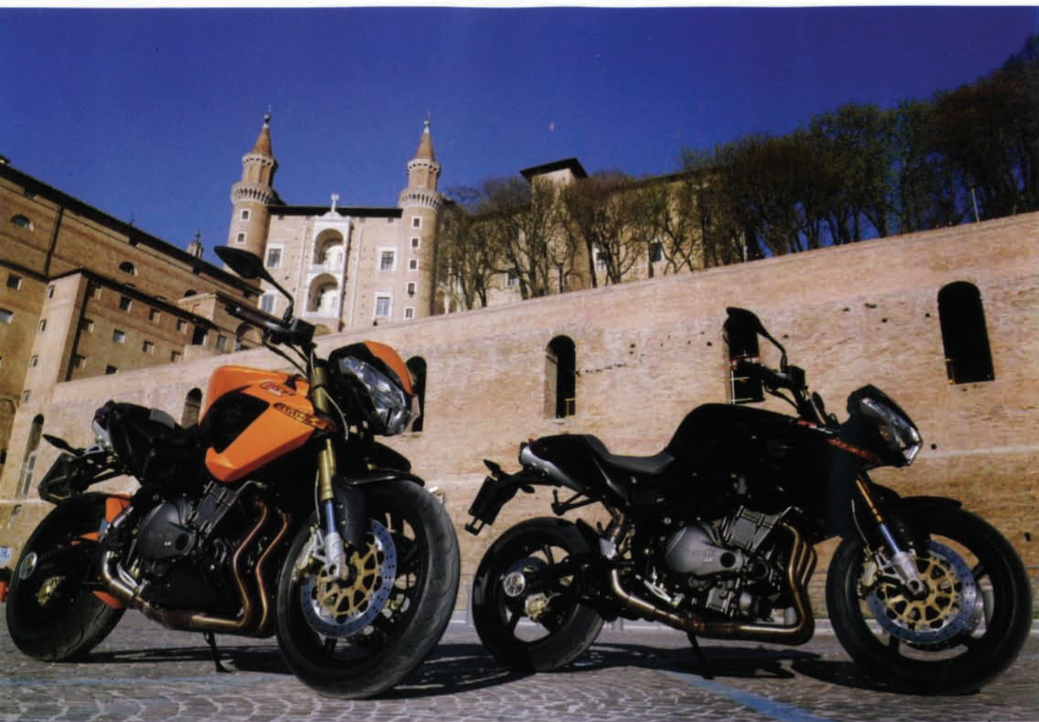
Le due versioni della Benelli TNT 899: a sinistra la S, disponibile nella sola livrea arancio e con forcella regolabile, mentre a destra vediamo la Base, con forcella non regolabile di maggior diametro, prevista nel solo colore nero.
