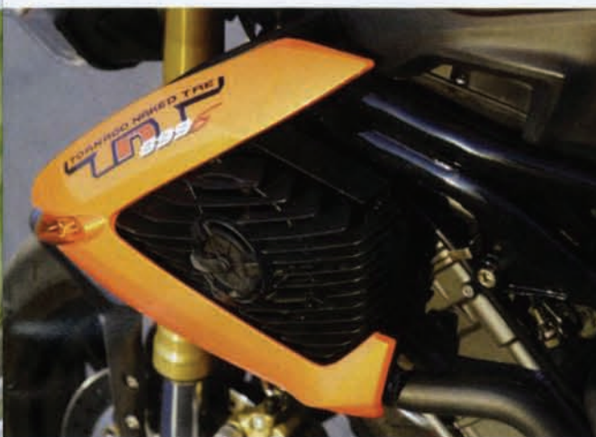
A sinistra, i radiatori del liquido di raffreddamento: nella carenatura sono alloggiati gli indicatori di direzione. A destra, l'inconfondibile frontale con il gruppo ottico sdoppiato. In basso a sinistra, la TNT 899 base (nera) e la "S" arancione.
